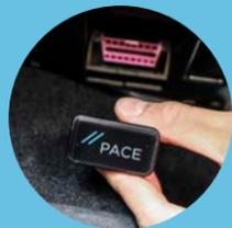
**Schritt 2:** Wir mussten uns ziemlich verbiegen, um an die OBD2-Schnittstelle zu kommen. Steckt der Adapter, muss er vor der Verbindung für mehrere Sekunden gedrückt werden.
